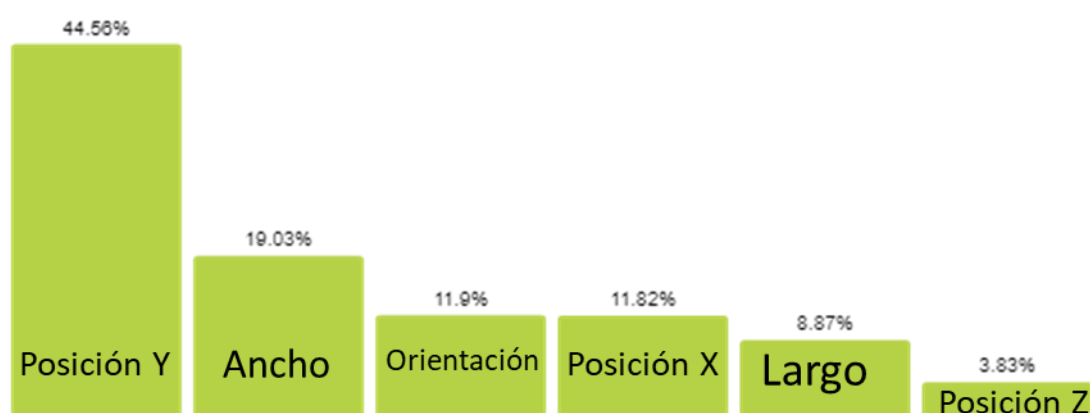
Ilustración 52. Influencia de las variables en el Modelo de IA para el ancho de la pieza
