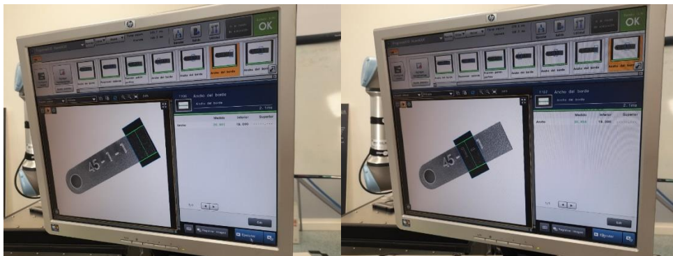
Ilustración 27. Mediciones del ancho en el extremo y en el centro (Fuente: elaboración propia AIDIMME)
